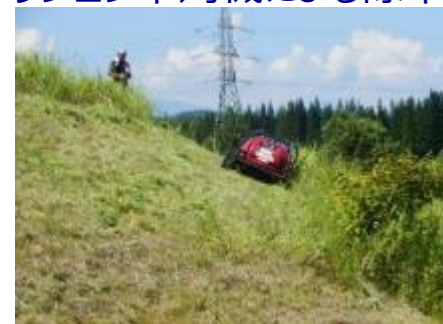
ラジコン草刈機による除草
