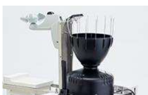
雨量計(転倒ます)
