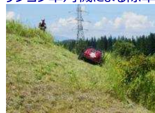
ラジコン草刈機による除草
