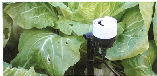
写真2 屋外自動灌水装置向きの雨センサ GTS101 の設置例
