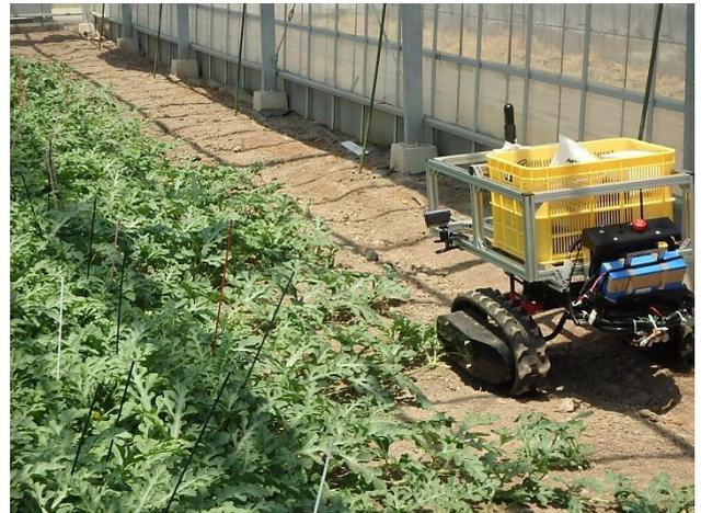
ドローン、移動台車による着果棒の認識テスト
