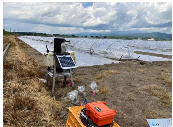
実証圃場の土壌水分を、土壌水分センサーで モニタリングしている状況
