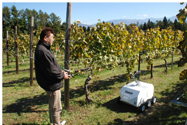
サンクゼールのブドウ畑を撮影する無人走行車。衛星データと地上の写真などを組み合わせてブドウの状態を把握する
