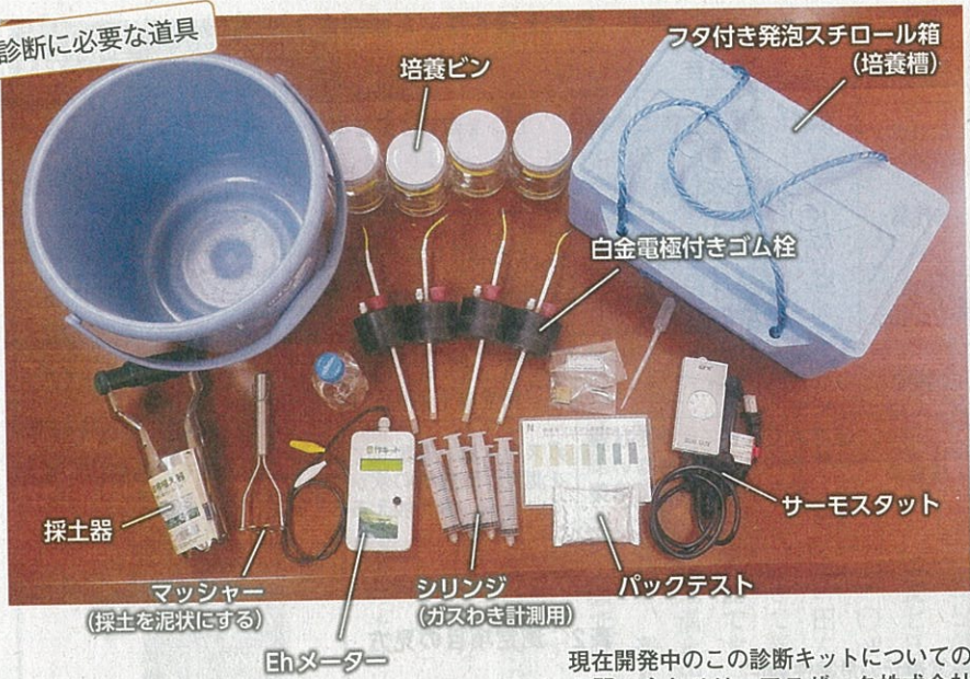
培養ビンで異常還元（Eh）とガスわき量を測る
