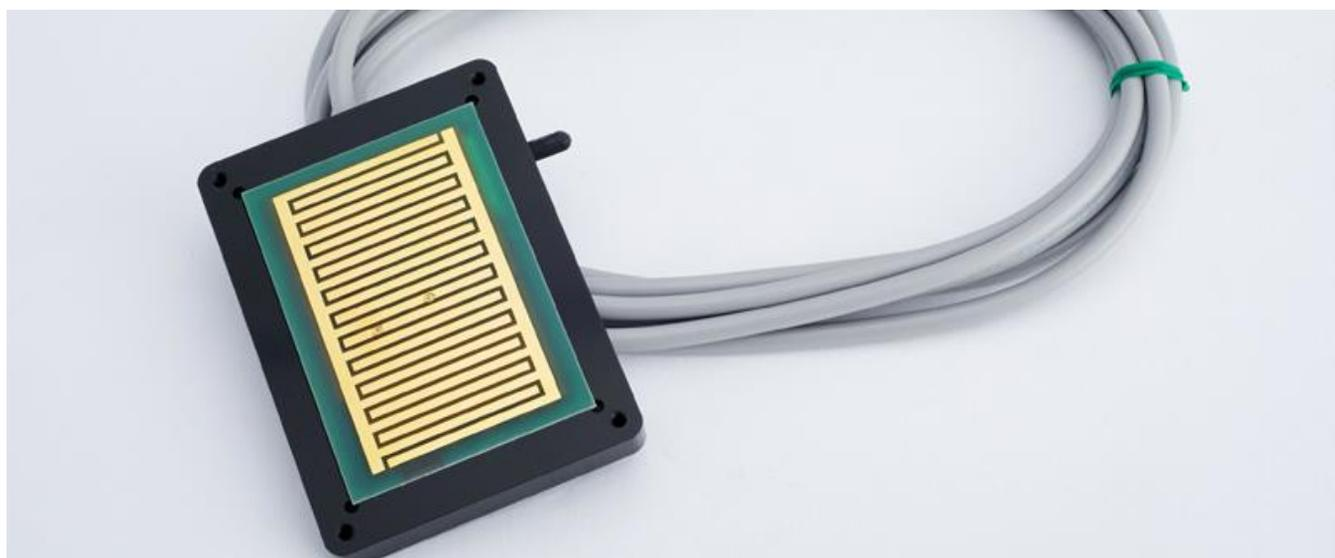
水分検知センサと温度センサを組み合わせることで、水分の検知状態をそのまま出力する「雨」出力と、設定温度(2℃または4℃)以下で水分を検知した場合の「雪」出力の2つを出力するセンサです。
