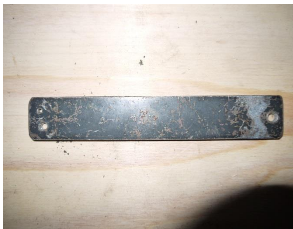
写真7 「ひかえ線」等を自作する自作工具
