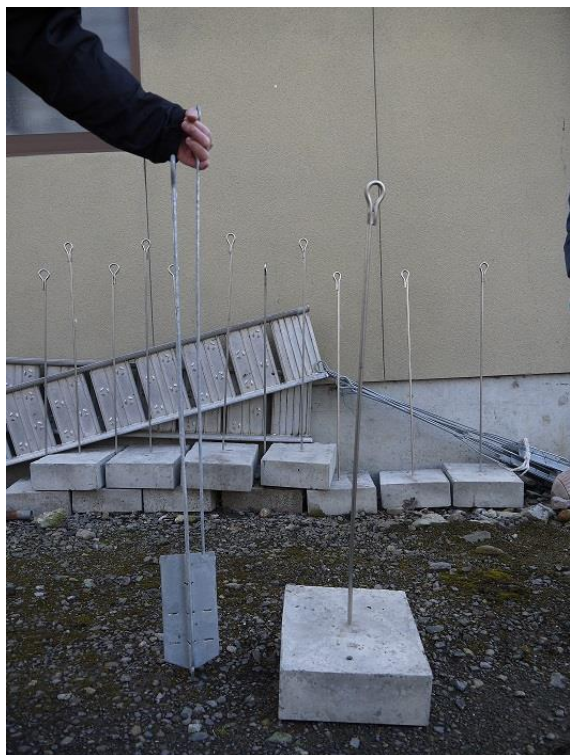
写真 1 2 アンカー 2 種 左：打ち込みアンカー （打ち込み工具が必要） 右：埋め込みアンカー
