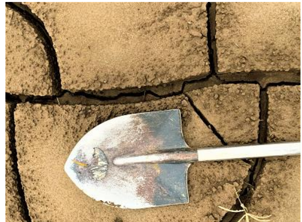
図 2 堆積した泥土に発生した幅 2～5 cm クラック
