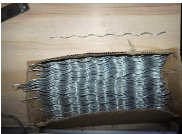
写真10 「針金」クロス部を固定する 「巻き付けクリップ」(グリグリ)
